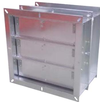
Клапан противопожарный избыточного давления LKI предназначен для поддержания требуемого избыточного давления от 20 до 150 Па в помещениях тамбур-шлюзов, лестничных клеток, лифтовых шахт и др., а также для возмещения объемов удаляемых продуктов горения из помещений, защищаемых вытяжной противодымной вентиляцией, согласно требованиям СП 7.13130.2013.
