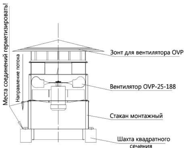
установка на монтажном стакане
