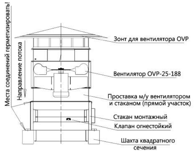
установка на монтажном стакане с огнестойким клапаном
