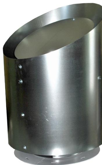
Принцип действия гибридного вытяжного устройства основан на совместной работе естественной и механической системах вентиляции. При наличии разницы температур внутреннего и наружного воздуха возникает естественная тяга и, как следствие, движение воздуха. При недостаточной разнице температур и дополнительную разницу давлений обеспечивает вентилятор с плавным регулированием скорости вращения рабочего колеса.
