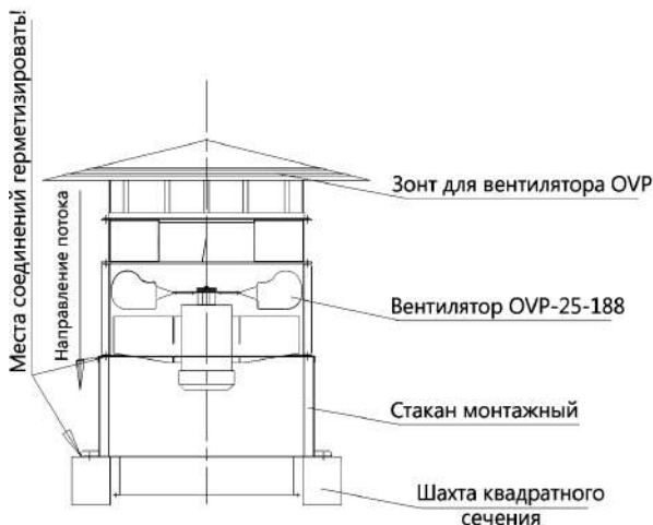
установка на монтажном стакане
