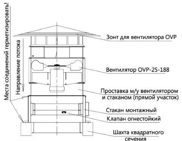
установка на монтажном стакане с огнестойким клапаном
